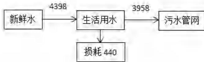
图 3-3 水平衡图 (单位: t/a)
